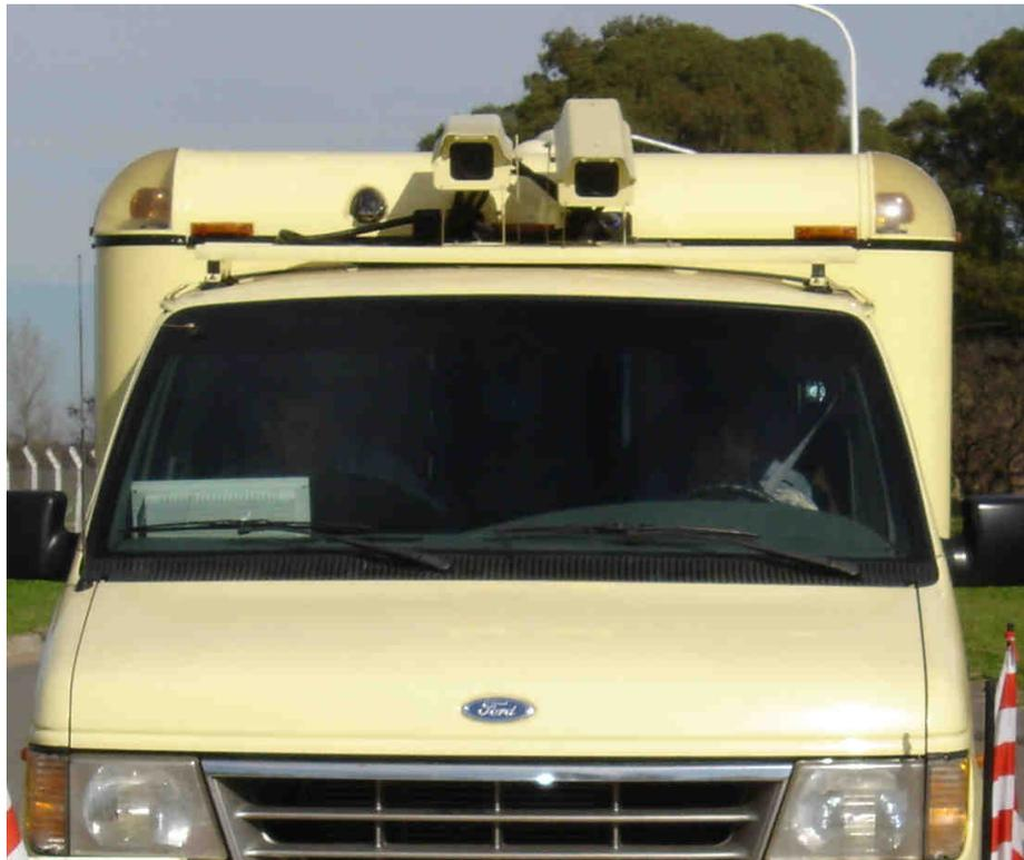
El ARAN dispone de 3 o mas cámaras de video con 2448 x 2048 pixel, calidad superior a HD y , con sensores CCD de 2/3"
