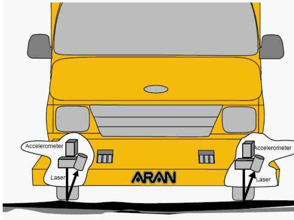
El sistema de medición de rugosidad del ARAN está formado por dos sensores láser y por dos acelerómetros que corrigen las mediciones eliminando los errores generados por movimientos propios del vehículo.
